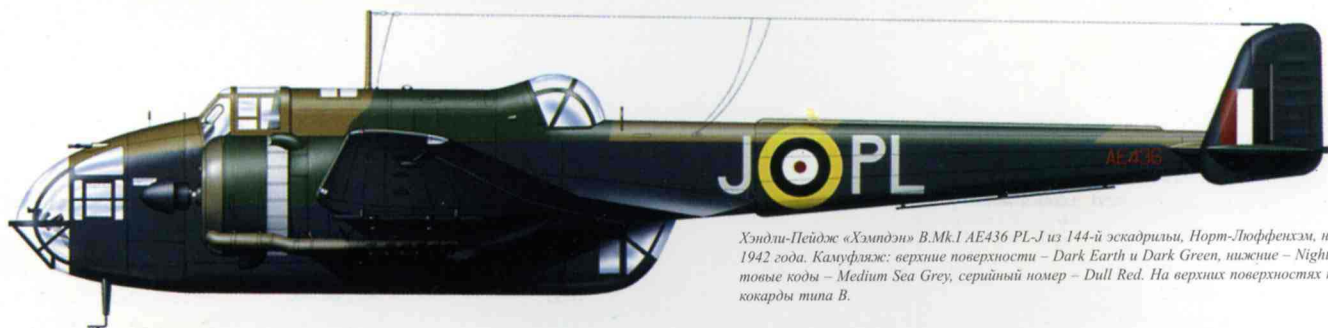
Хэндли-Пейдже «Хэмпдэн» В.Мк.1 AD915 PT-F из 420-й эскадрильи RCAF, Вэдингтон, февраль 1942 года. Камуфляж: верхние поверхности – Dark Earth и Dark Green, нижние – Night, бортовые коды – Medium Sea Grey, серийный номер – Dull Red. На верхних поверхностях крыла кокарды типа В.
