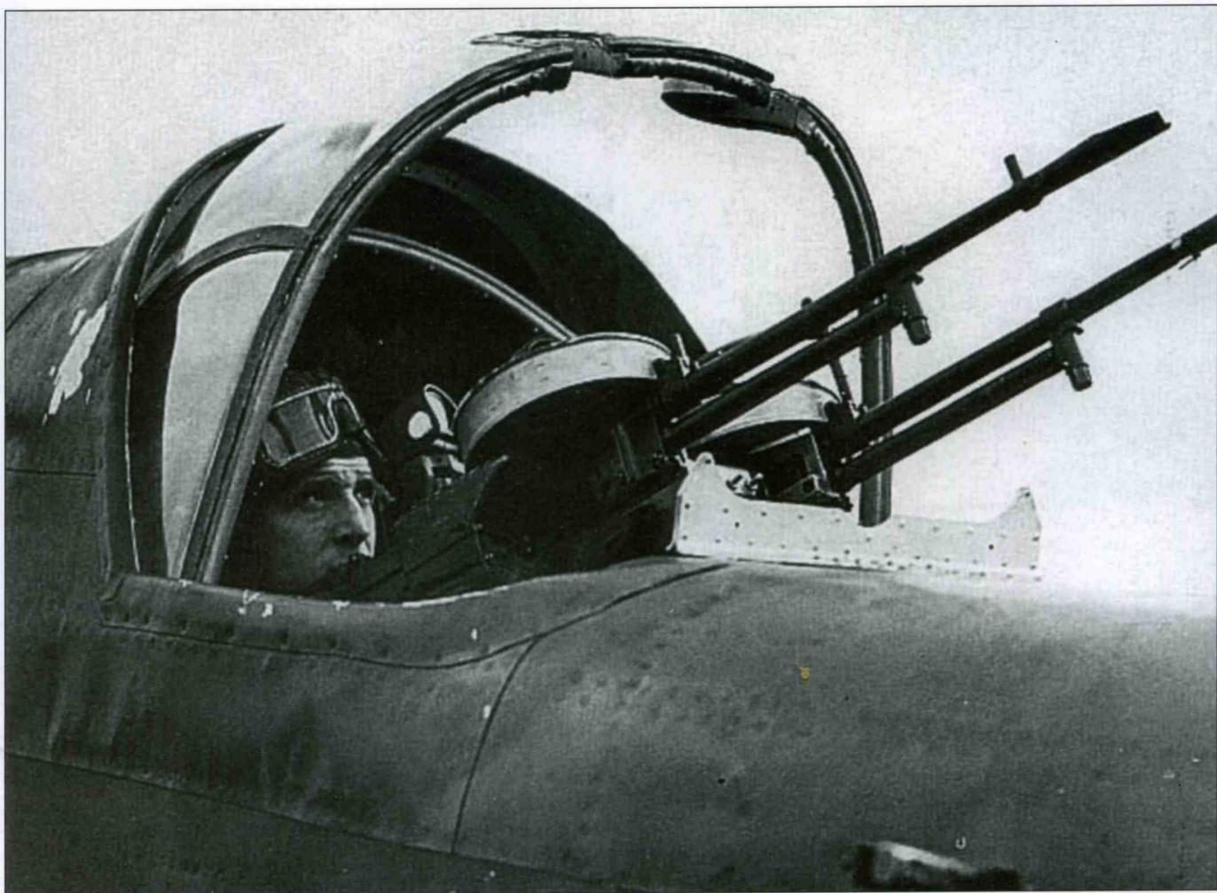
Спаренные 7,7-мм пулеметы Виккерс в верхней стрелковой точке. Виден ограничитель в виде металлической пластины, не позволявший стрелку случайно попасть в оперение собственного самолета.
