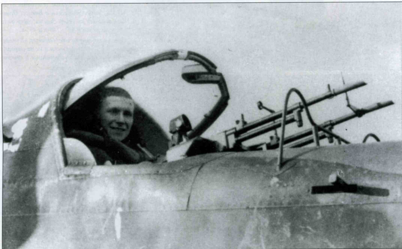
Верхняя стрелковая точка со спаренными пулеметами Виккерс. Еще один вариант конструкции ограничителя сектора стрельбы, на этот раз из трубок.
