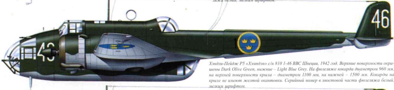
Хэндли-Пейдж P5 «Хэмпадэн» с/н 810 1-90 ВВС Швеции, 1938 год. Верхние поверхности окрашены Dark Olive Green, нижние – Light Blue Grey. На фюзеляже кокарда диаметром 800 мм, на верхней поверхности крыла – диаметром 1100 мм, на нижней – 1500 мм. Кокарды на крыле не имеют желтой окантовки. Серийный номер в хвостовой части фюзеляжа белый, мелким шрифтом.
